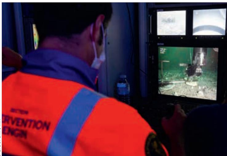
Un marin de la Cephismar appose une plaque obturatrice sur l'épave du *Tanio* à l'aide d'un ROV (*Remotely Operated Vehicle*).
